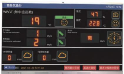
▲屋外サインージで計測したデータを室内用タッチモニターでも閲覧可能。
